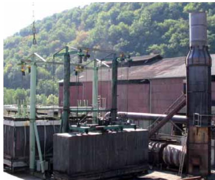
Transformation par thermolyse de déchets de bois créosotés en charbon de bois dans l'entreprise Sidénergie (46)
