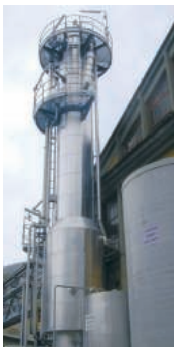
Évaporateur à compression mécanique de vapeur
