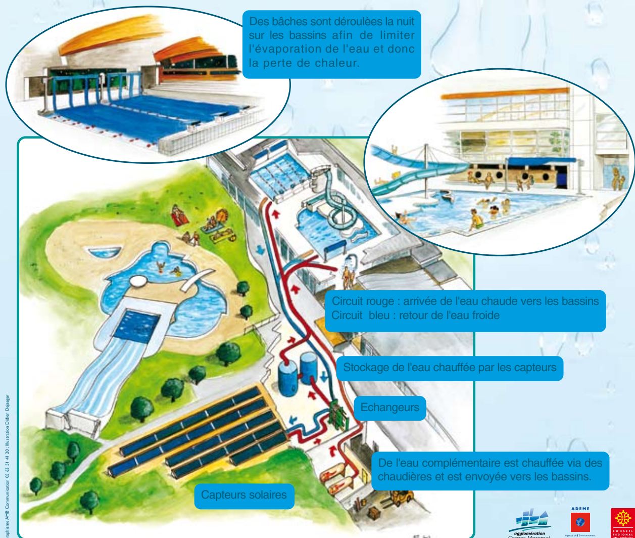
Schéma de fonctionnement du chauffage de l'eau à la piscine l'Archipel de Castres (81).
