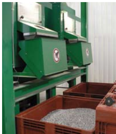
Métaux non ferreux broyés en fin de process.
