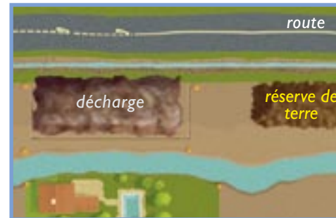
De grosses quantités de terres sont nécessaires. Anticiper la réhabilitation permet de réserver, à proximité, des matériaux terreux propres excédentaires provenant d'autres travaux.
